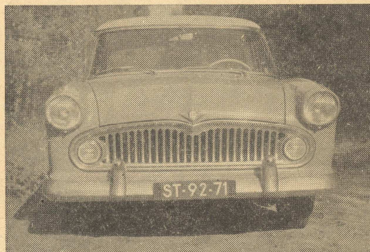
Het uiterlijk van de „Versailles” valt o.m. op door de sterk teruggebogen grille en de grote gebogen voorruit.
